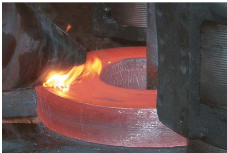
Forgiatura degli anelli di trafilatura in ALBROMET 380 sul laminatoio
